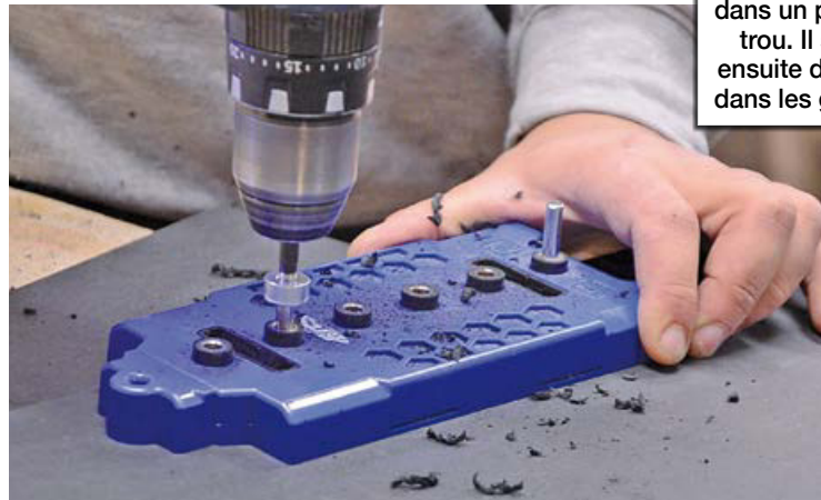
Avec cette configuration, l'emplacement de chaque partie de la charnière sont à deux cotes différentes.
