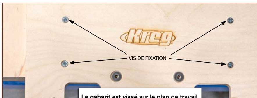
Le gabarit est vissé sur le plan de travail.
