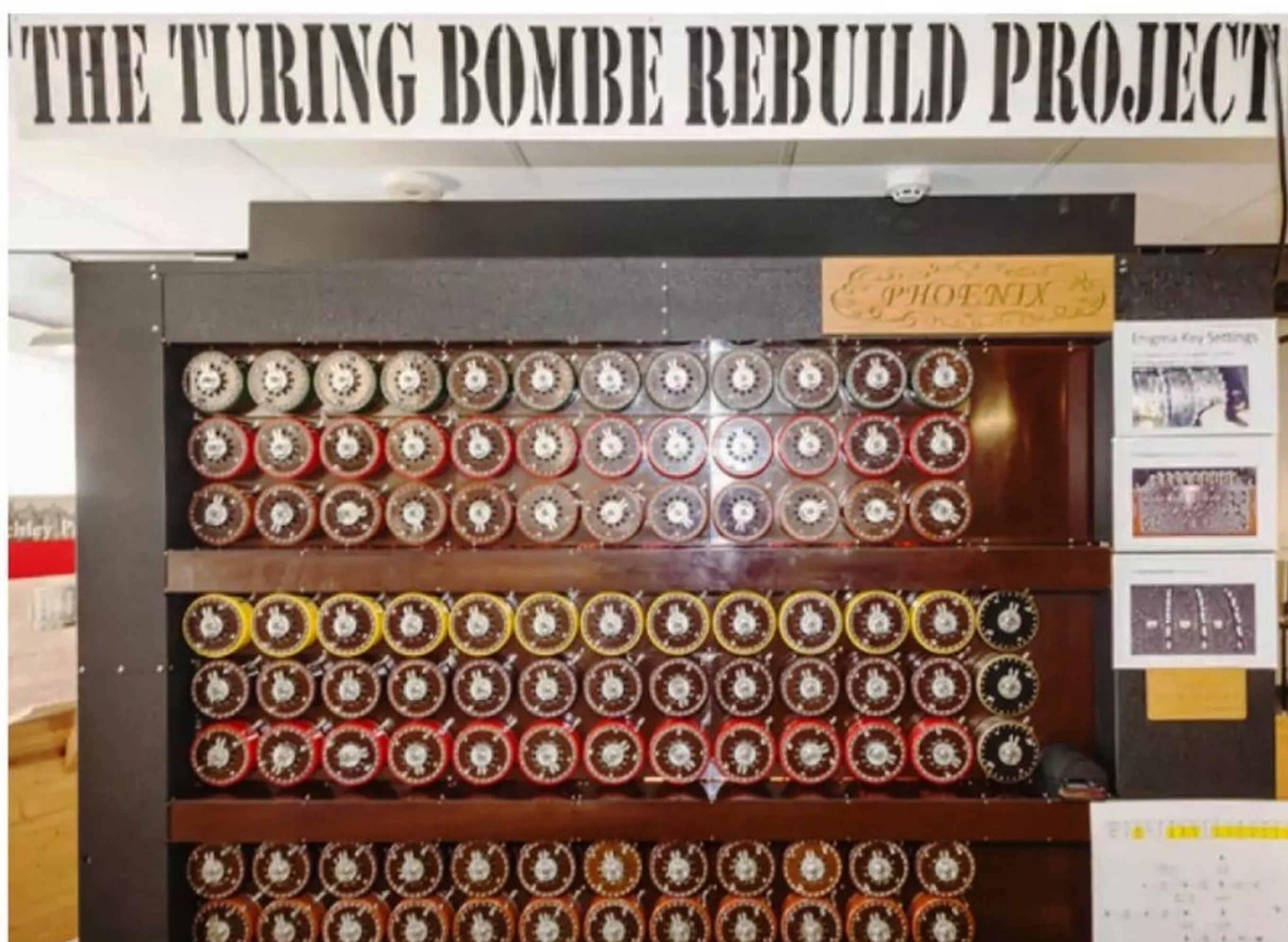
Réplique Semblables à cette reconstitution, des machines appelées « Bombes » ont été conçues à partir de 1939 par Turing pour casser les codes d'Enigma.
