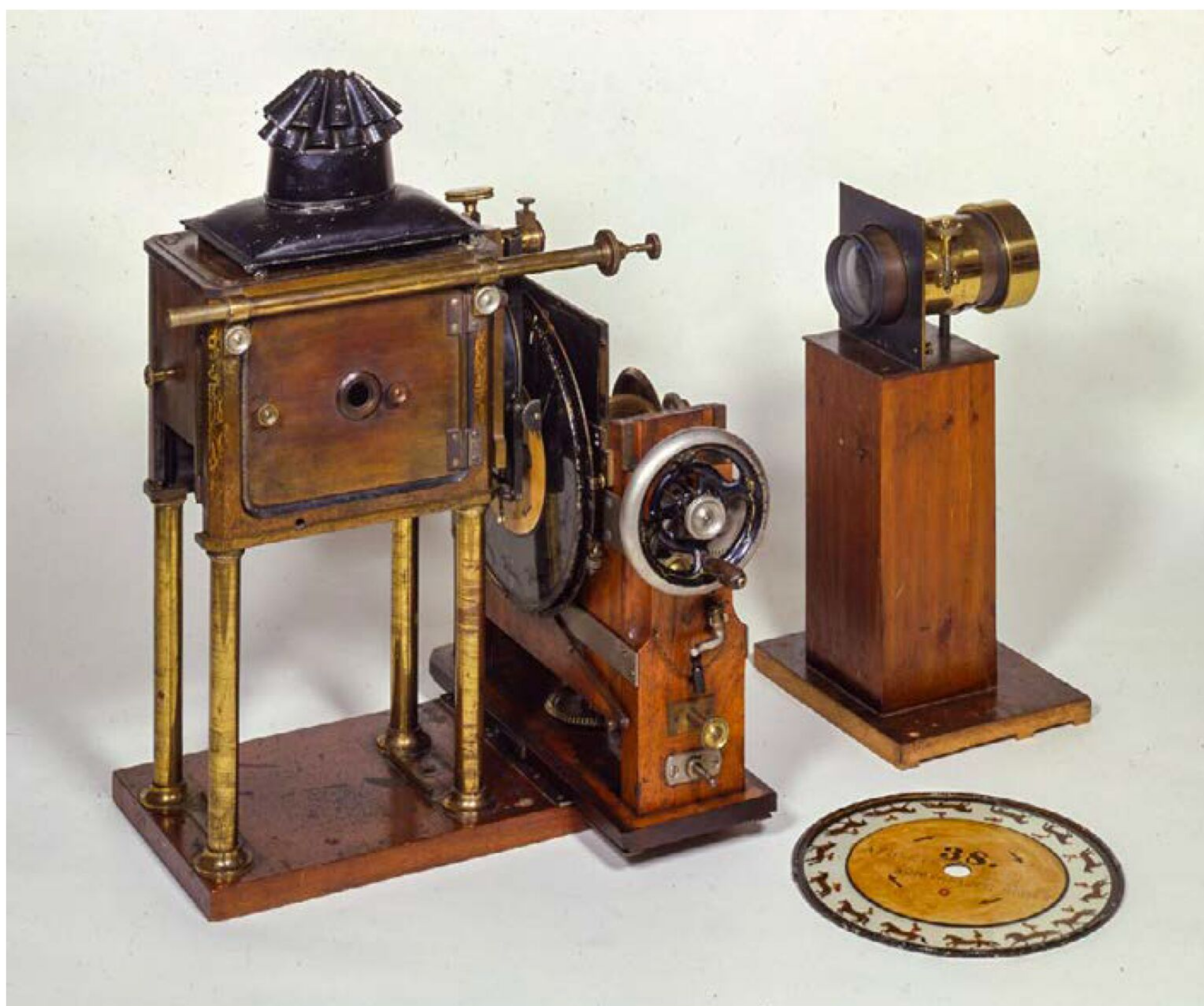
Quand l'image prend vie Muybridge invente le zoopraxiscope (ci-dessus) en 1881, composé d'une lampe, d'une lentille et d'un disque en verre sur lequel sont imprimés des dessins réalisés à partir des clichés. Un tour de manivelle et les images s'animent.
