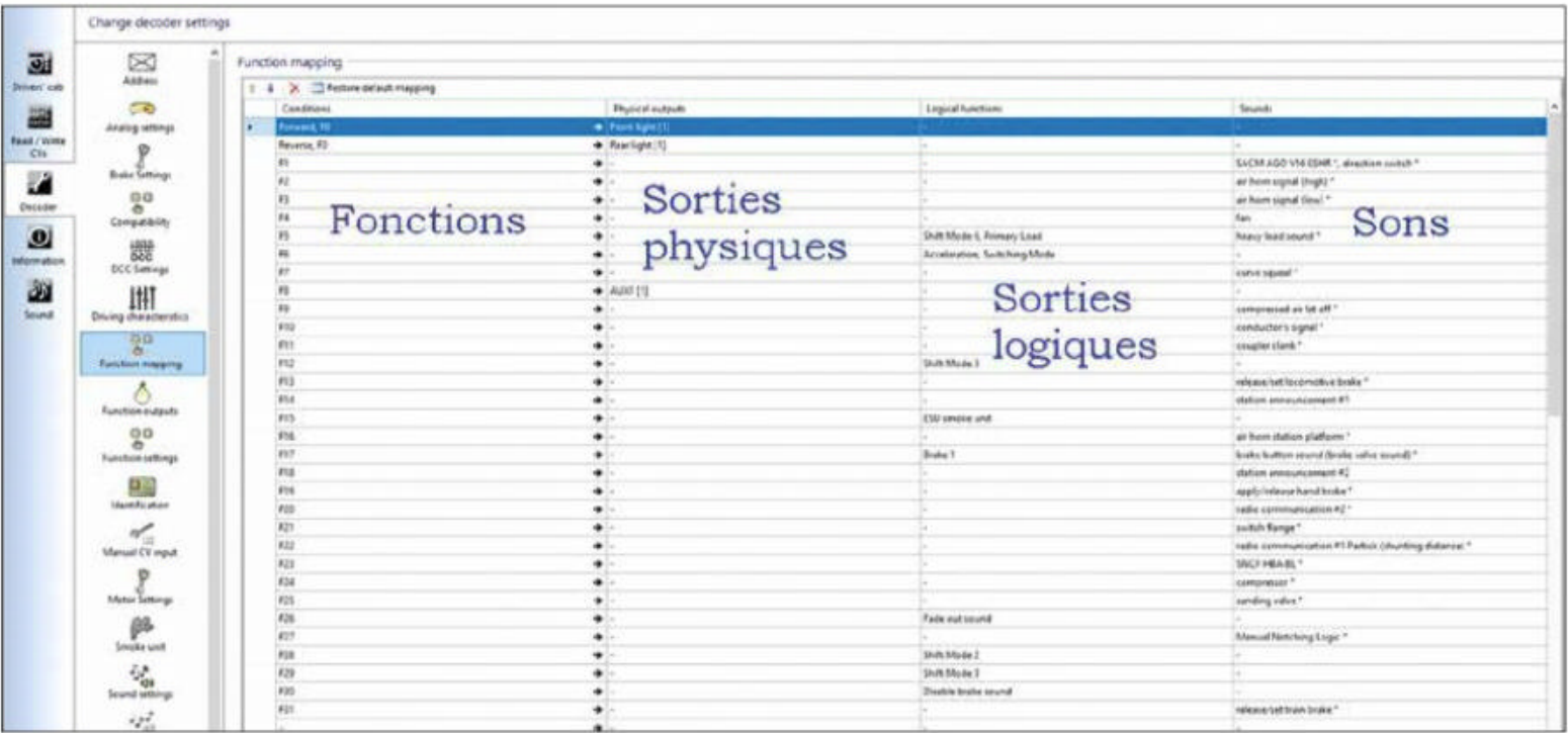
FIGURE 1. Aperçu des attributions des fonctions : le « fonctions mapping », mis en évidence par le logiciel Lokprogrammer.
