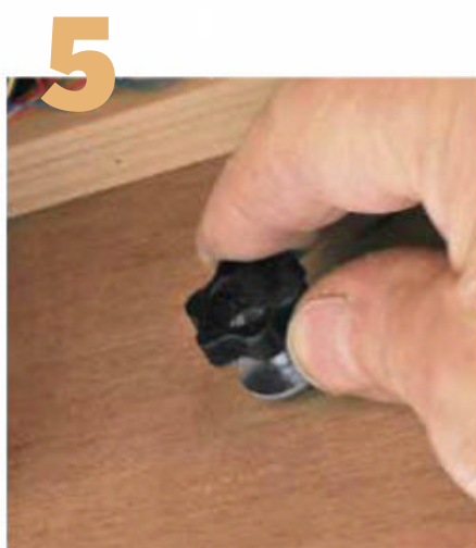
La molette peut facilement être serrée à la main. Les modules retrouvent quasiment leur position avant perçage.
