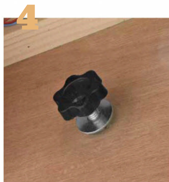
Une fois les modules approximativement repositionnés, on munit les molettes d'une rondelle ; on commence le serrage, on vérifie et règle au besoin l'alignement, et on visse à fond.
