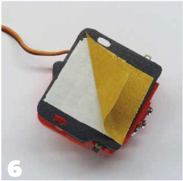
5 Durant le temps de la mise en place du moteur, je conseille d'immobiliser les lames d'aiguille en position médiane par un morceau d'adhésif. 6 Un coupon d'adhésif double face fixera provisoirement chaque moteur d'aiguille, mais il faudra renforcer l'immobilisation par au moins une vis sous la plateforme de voie.
