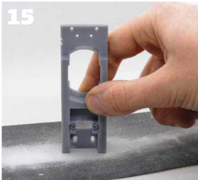
La surface en contact avec les supports est légèrement poncée afin de l'égaliser.
