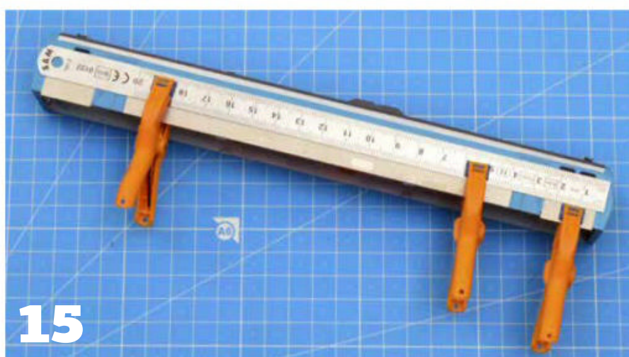
15 Petite astuce : utilisez un réglet et des pinces pour positionner correctement les flancs.
