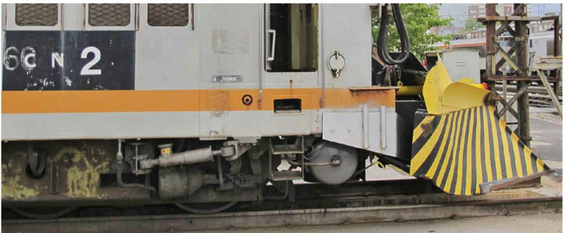
Vue de la traverse de tamponnement et des tôles latérales de support du soc.
