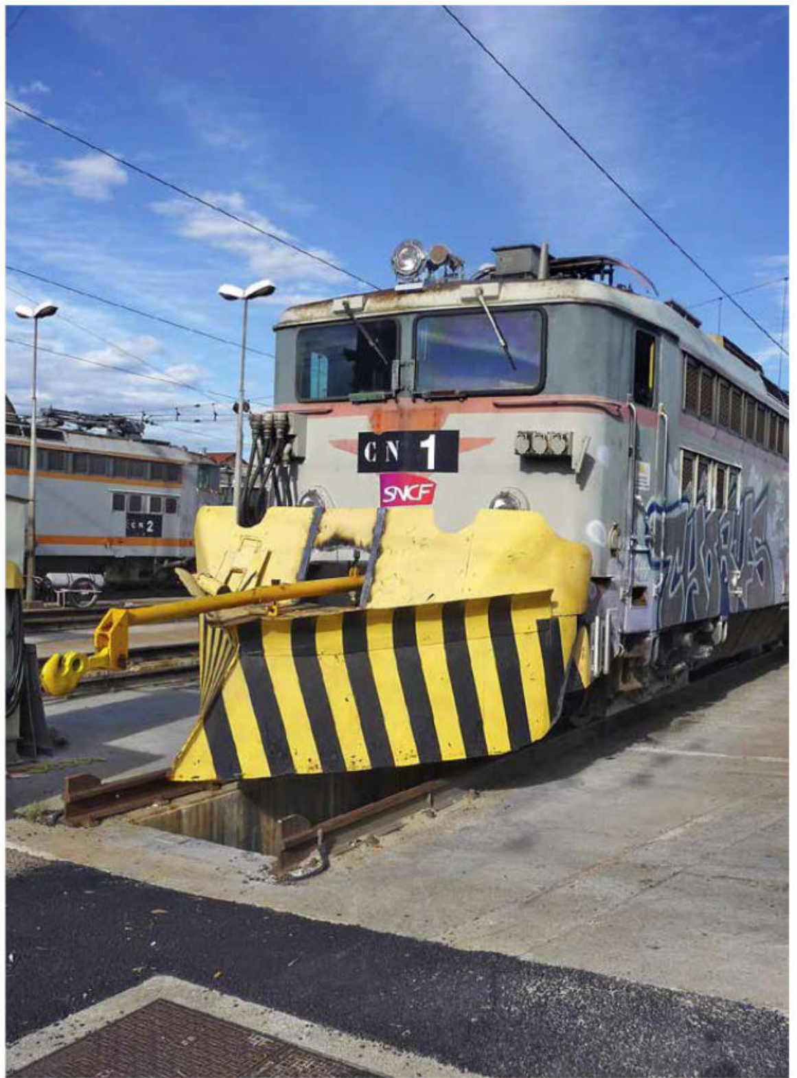
Le CN 1 à Toulouse-Pérolle en septembre 2015. Notez la barre d'attelage nécessaire à son acheminement par un autre engin.
