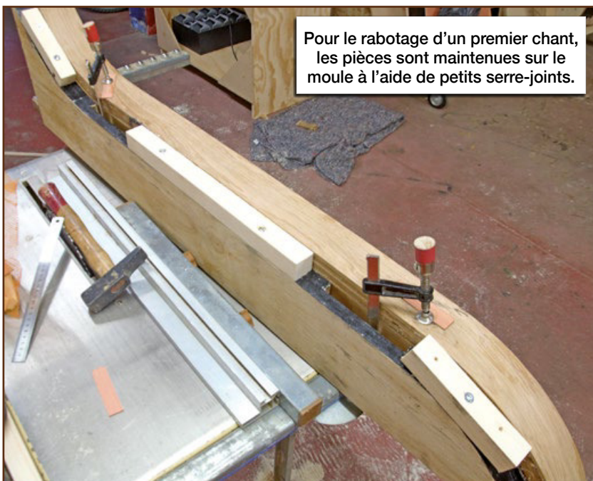
Collage des quatre pièces pour constituer la console.
