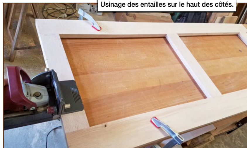
Usinage des entailles sur le haut des côtés.
