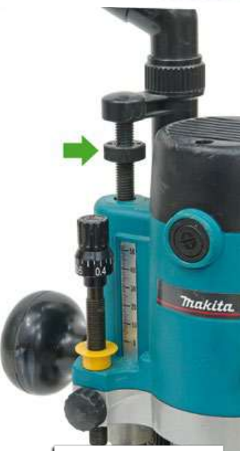
L'écrou prisonnier de la Makita RP 1110 C.
