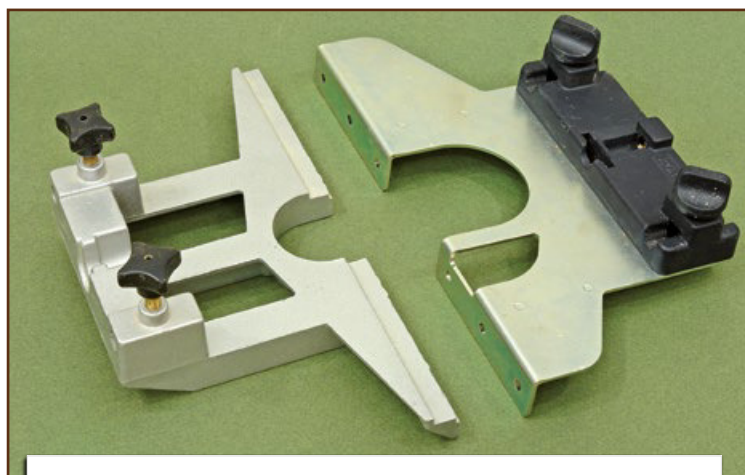
Un guide parallèle en fonte d'aluminium (Perles OF 808), et un autre en tôle pliée (Festool OF 1010), barres et joues retirées.
