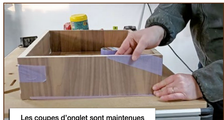
Les coupes d'onglet sont maintenues avec de l'adhésif puis mises sous presse.
