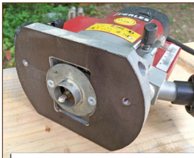
Un guide à copier monté sous la base d'une défonceuse.
