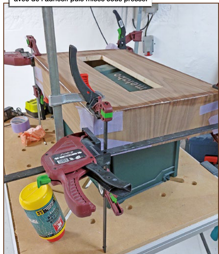
Les coupes d'onglet sont maintenues avec de l'adhésif puis mises sous presse.
