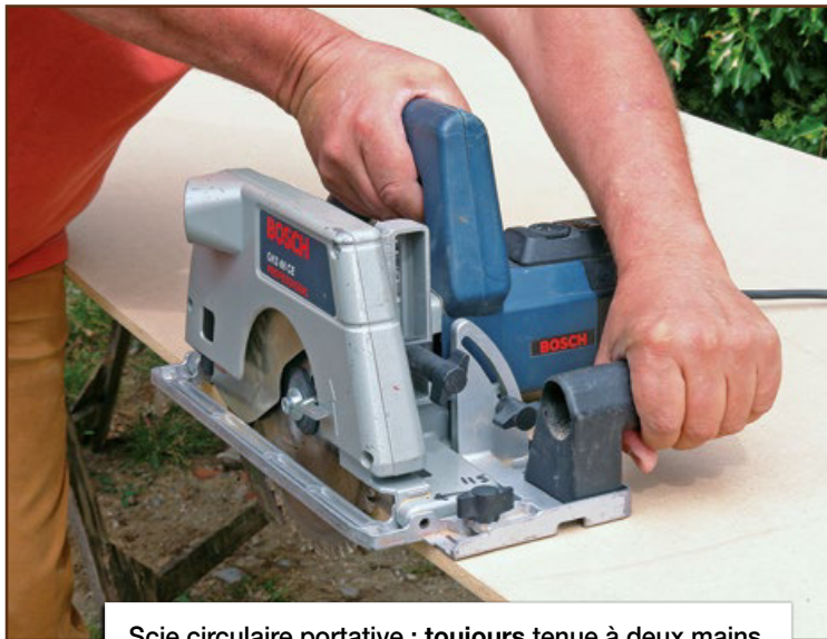
Scie circulaire portable : toujours tenue à deux mains.
