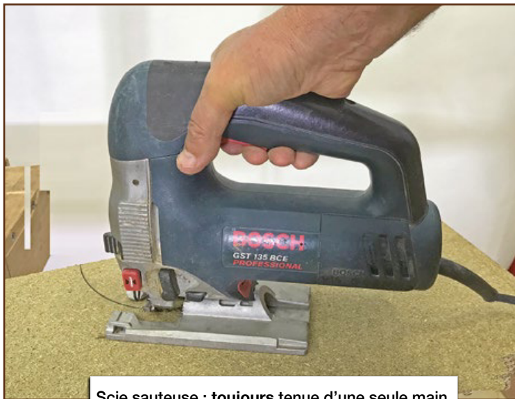
Scie sauteuse : toujours tenue d'une seule main.
