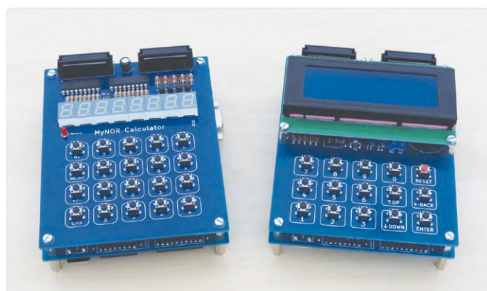
Figure 4. À gauche la calculette de poche et à droite le MyNOR avec le(s) clavier(s) et l'écran.
