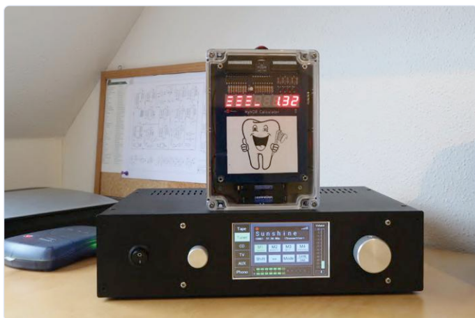
Figure 5. Minuterie de brosse de dents avec MyNOR v1.0 plus l'affichage à 7 segments v1.0. L'appareil sur lequel est posée la minuterie est un récepteur haut de gamme (FM et DAB+) avec égaliseur à 11 bandes intégré et commande tactile, construit par Dennis l'an dernier.
