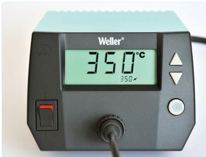
Figure 2. Affichage de la température de la panne et, en dessous, de la consigne.
