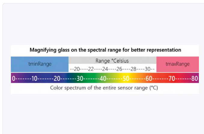
Figure 8. Le domaine de mesure est étendu à la partie souhaitée du spectre.
