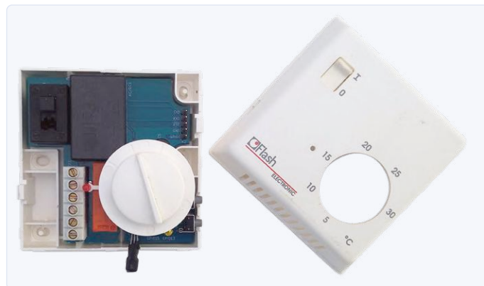
Figure 5. Après quelques ajustements mineurs du boîtier de l'ancien thermostat (un peu de plastique coupé), la nouvelle carte s'adapte parfaitement.
