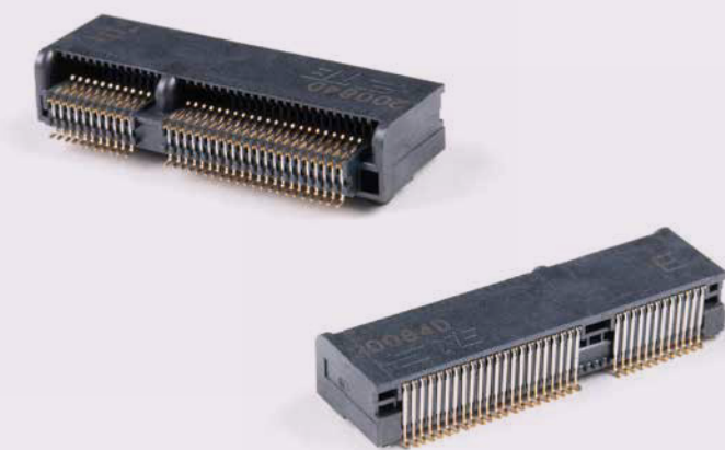
Figure 1 : Vue avant (en haut) et vue arrière (en bas) du connecteur M.2.
