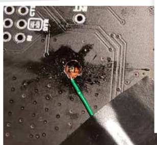
Figure 14c: Le fil a été soudé avec succès à travers le circuit imprimé.
