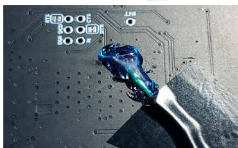
Figure 14d: Trou bouché et fil immobilisé par la colle chaude.
