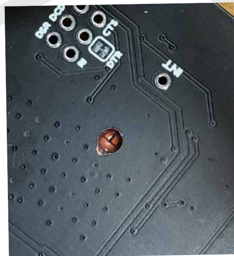
Figure 13 : L'alcool rend le FR4 transparent.
