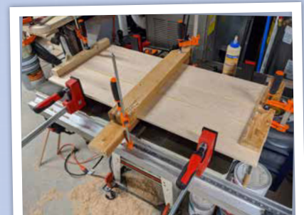
... contrecollés ensuite pour faire la façade...
