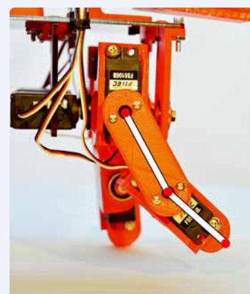
Figure 3. Les deux systèmes utilisent deux servos pour contrôler la position des pattes, mais de manière très différente.
