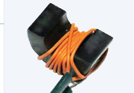
Figure 4. De multiples tours autour du noyau augmentent la sensibilité.
