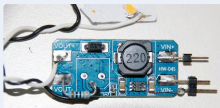
Figure 5. Un Arduino Uno et un module MT3608 modifié contrôlent ensemble la luminosité d'une chaîne de LED.
