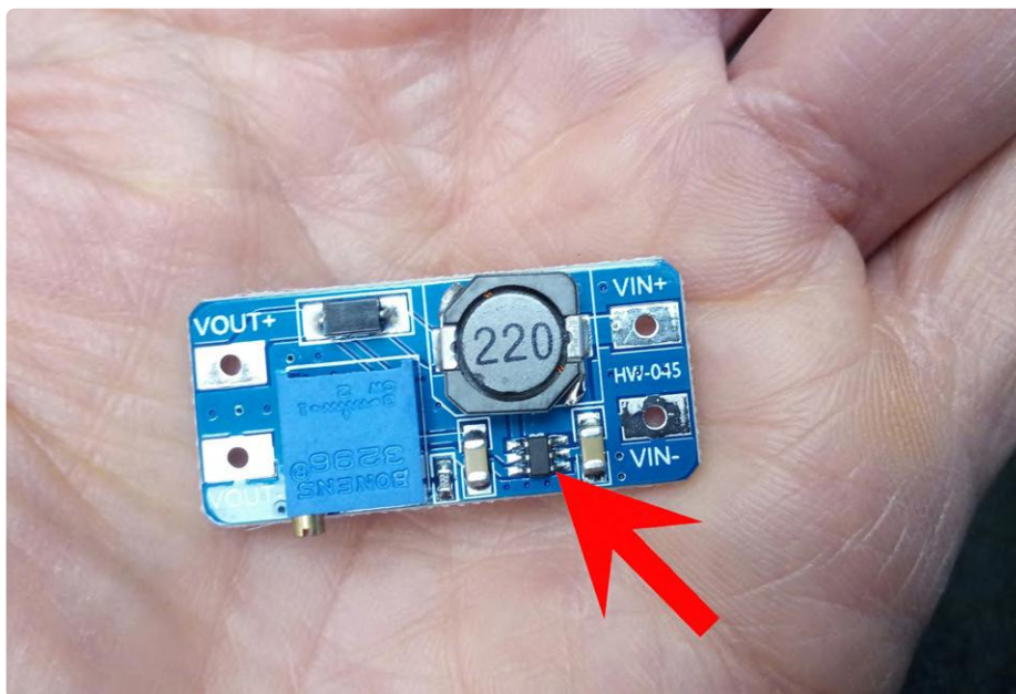
Figure 1. Bon marché, le module convertisseur élévateur MT3608 peut fournir jusqu'à 28 V à partir d'une tension d'entrée \geq 2 V.
