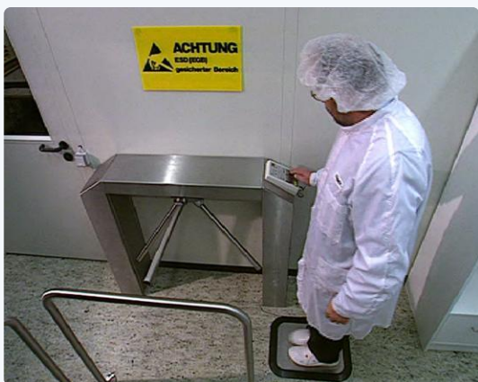
Figure 9. Barrière de contrôle de la conductivité.
