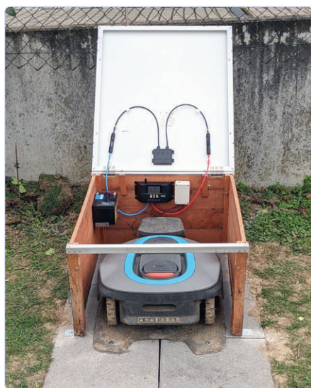
Figure 10. Tout est terminé : garage solaire avec électronique intégrée.
