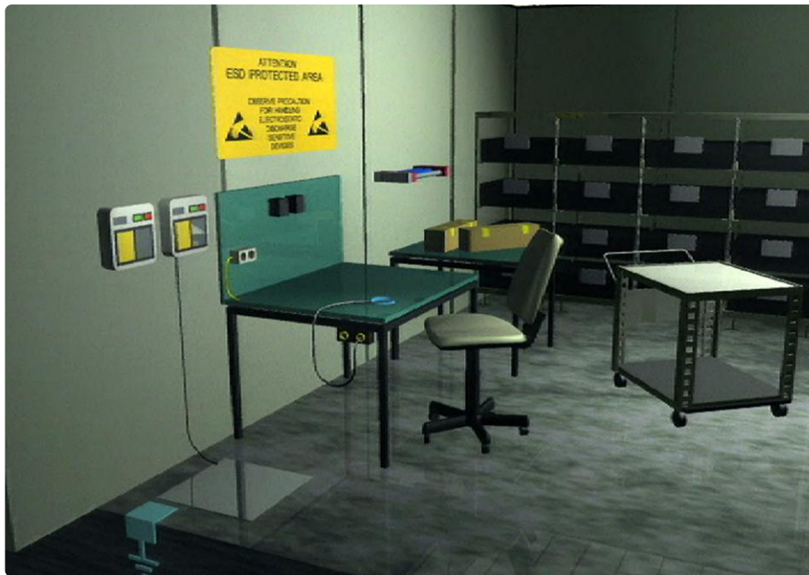
Figure 5. Lieu de travail équipé de toutes les mesures anti-ESD.
