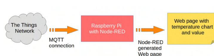
Figure 4. Flux de données entre The Thing Network et la page web de l'utilisateur.
