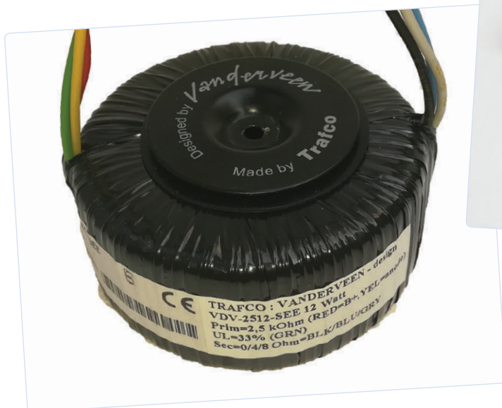
Figure 5. Un transformateur Vanderveen à noyau toroidal.
