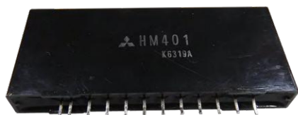
Figure 4. Entièrement encapsulé, ce pilote de climatiseur ne laisse aucune possibilité d'évaluer son fonctionnement.
