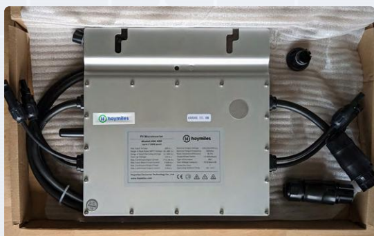
Figure 5. Onduleur HM-600, vue de dessous.
