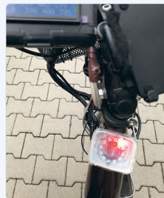
Figure 5 : La boussole assemblée et fixée au cadre de mon vélo.
