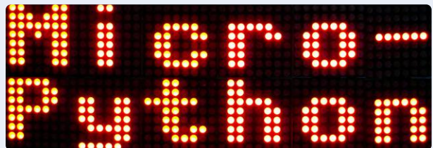
Figure 6. Affichage matriciel par points avec douze éléments de matrice.
