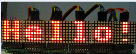
Figure 5. Affichage matriciel par points avec six éléments de matrice 8x8.
