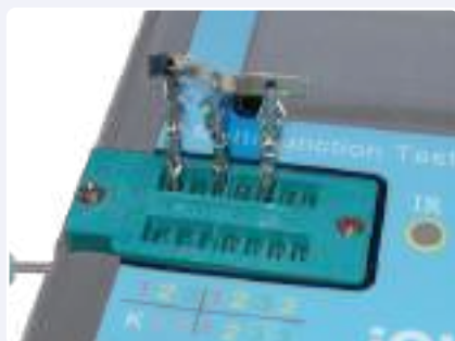
Figure 2. Calibrage avec une prise de test court-circuitée.
