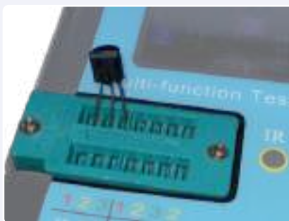
Figure 3. Test des composants dans le connecteur ZIF ou avec les clips de test.
