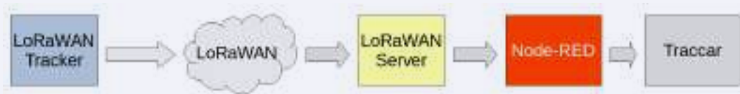
Figure 15. Exécuter Traccar avec Node-RED permet de recevoir les données des traceurs GPS LoRaWAN.
