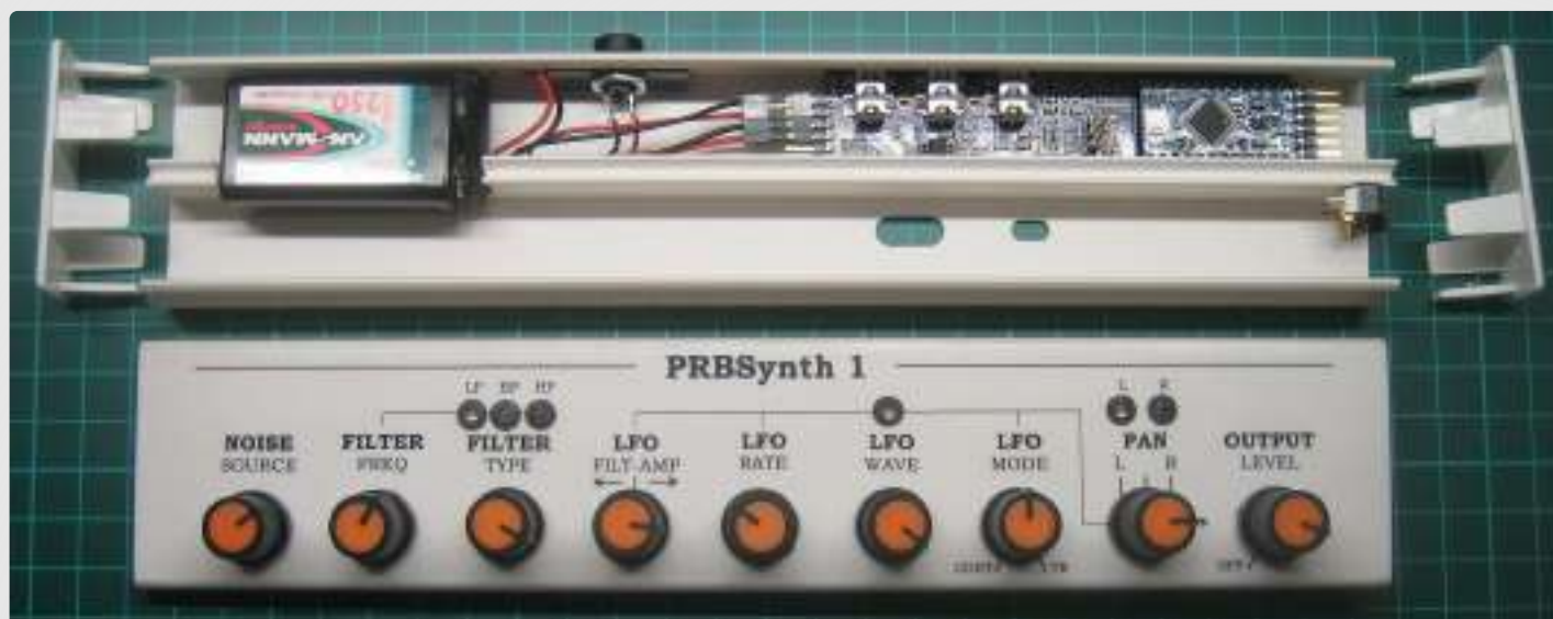
Figure 5. Le PRBSynth1 assemblé à l'intérieur d'une goulotte électrique en PVC. Pour garder le circuit imprimé petit et facile à intégrer, les LED et potentiomètres ne sont pas montés, mais câblés via des connecteurs. Une pile de 9 V alimente le circuit.
