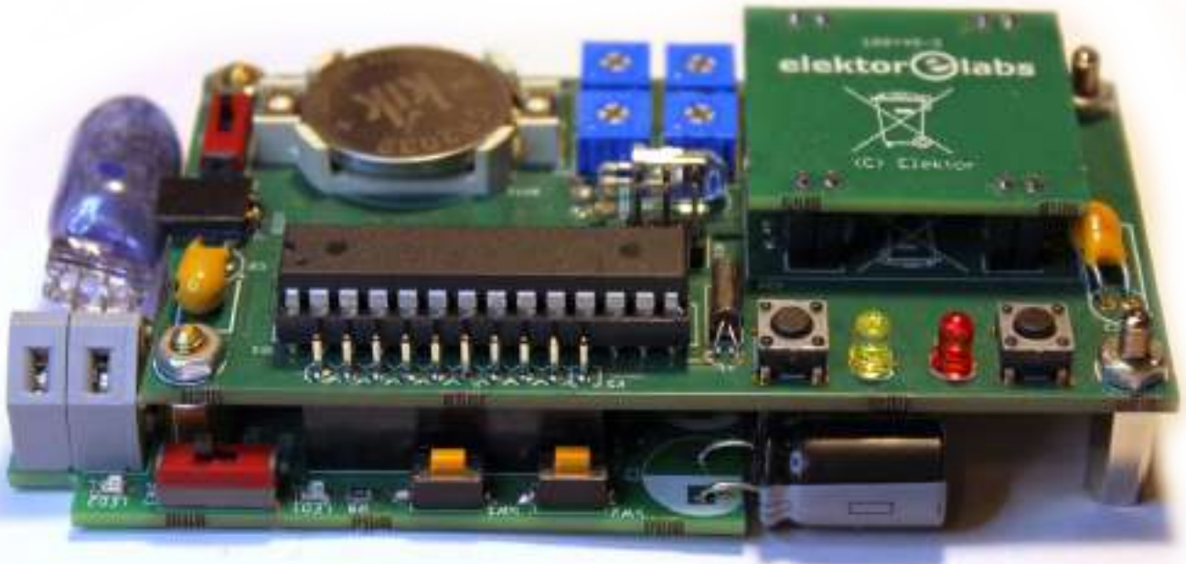
Figure 4. La carte d'extension avec ampoule de flash se branche en dessous de la carte principale de la BTE. Les deux boutons-poussoirs et son interrupteur sont accessibles sur le côté.
