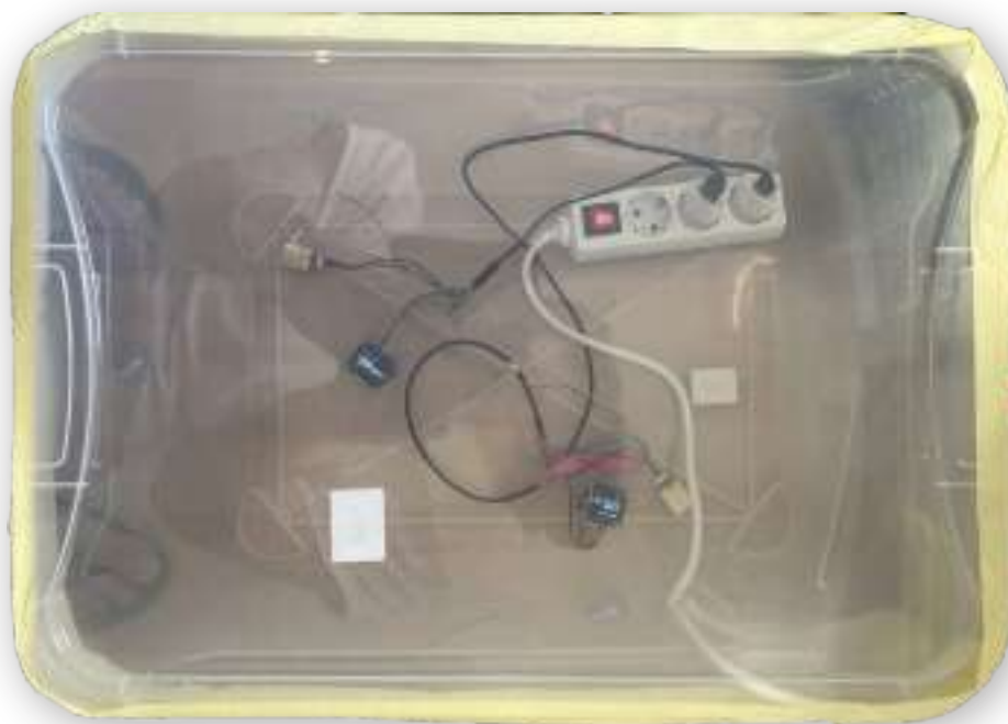
Figure 6. Test de différents capteurs avec des concentrations de CO 2 prédéfinies.
