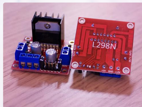
Figure 13. Le module L298N en double pont en H.
