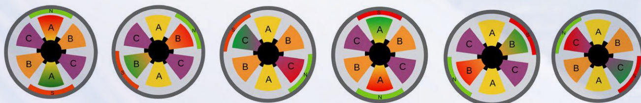
Figure 22. Le rotor est tiré par un champ magnétique.
