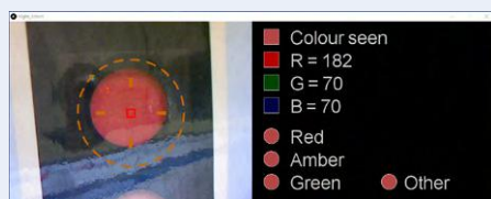
Figure 7. Réponse de tlight_detect.pde avant d'apprendre des couleurs.
