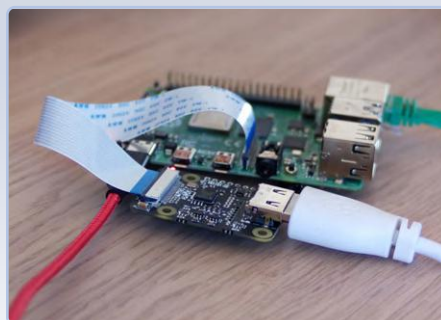
Figure 18. Installation terminée avec le pont HDMI-CSI.
