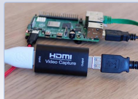
Figure 19. Installation terminée avec la clé d'acquisition HDMI-USB.
