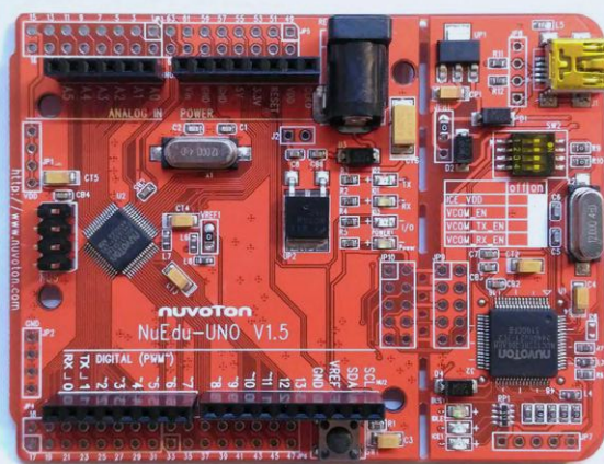
Figure 5. La carte NuMaker Uno de Nuvoton possède un module de programmation/débogage NuLink détachable. (Source : https://danchouzhou.blogspot.com )
