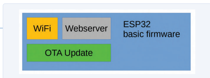
Figure 10. Blocs de base du microprogramme.
