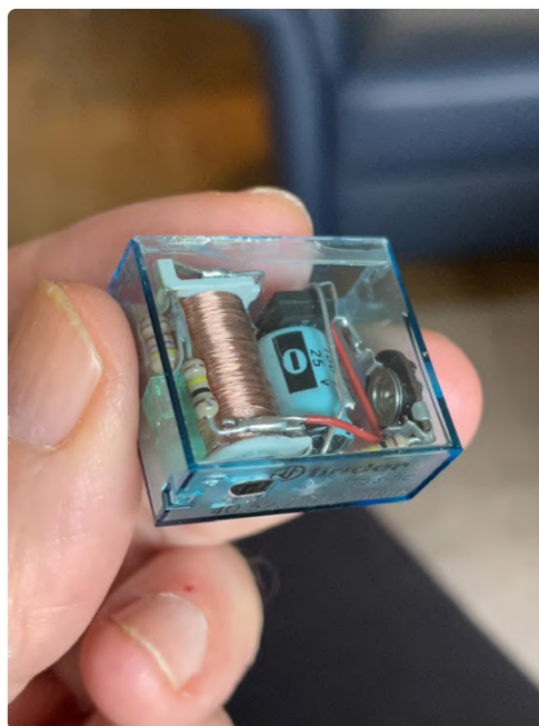
Figure 2. L'ajustable à un tour et la résistance en série tiennent dans le boîtier.
