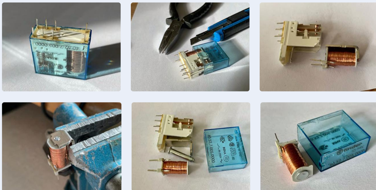
Figure 3. Démontage du relais et préparation du solénoïde.
