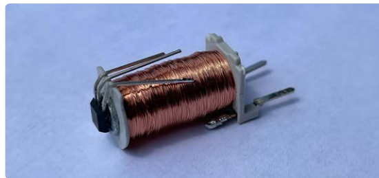
Figure 4. Le capteur à effet Hall collé au noyau de fer de la bobine.
