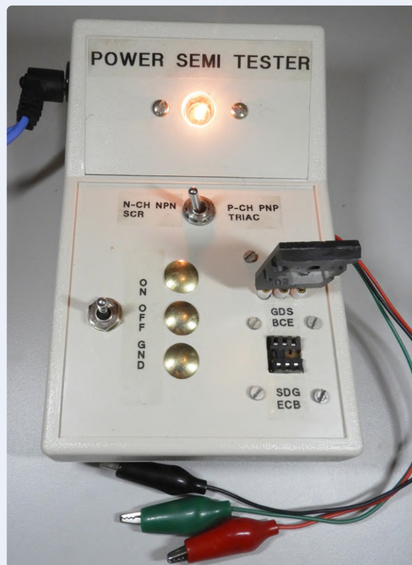
Figure 2. Un simple testeur de semi-conducteurs de puissance teste les MOSFET, les transistors, les thyristors et les triacs.
