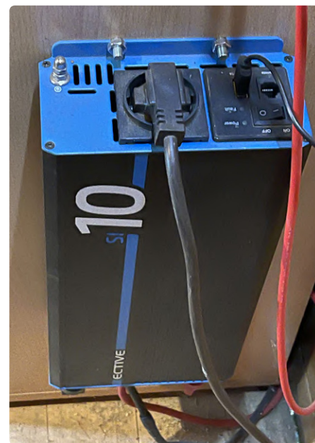
Figure 6. Cet onduleur de 1 kW fabriqué par Ective s'est révélé très stable et fiable au fil du temps.
