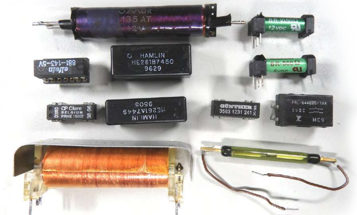
Figure 2. Une sélection de relais Reed. En haut à gauche, un relais inverseur (deux contacts à l'extrémité gauche). En bas à droite, un relais Reed nu. Les autres montrent la grande variété de tailles et de conditionnements disponibles.
