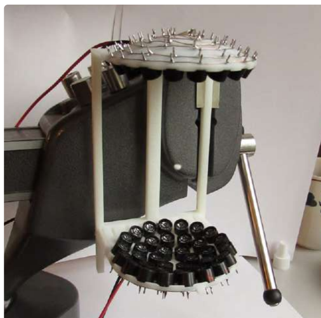
Figure 4. Une minuscule boule de polystyrène en vol stationnaire dans le TinyLev.
