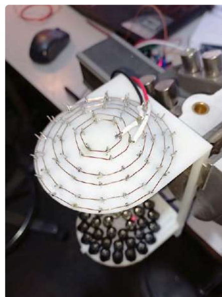
Figure 3. Le câblage de l'un des deux réseaux.
