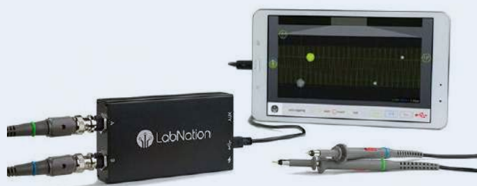
Figure 3. Un oscilloscope sans écran permet de gagner de la place sur la paillasse. Mais est-ce bien le cas ? Il faut un ordinateur ou une tablette pour visualiser les signaux.
