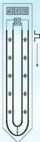
Figure 9. Principe de fonctionnement d'un capteur TDT. Le temps de propagation des impulsions du conducteur de la boucle, qui dépend de l'humidité, est converti en fréquence.
