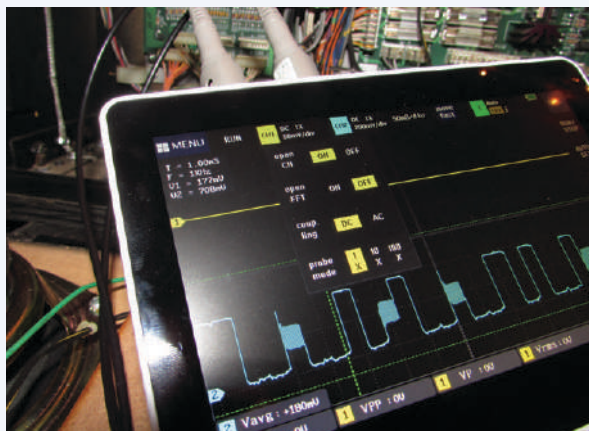
Figure 3. Menu des paramètres de la voie 1.
