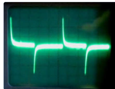
Figure 5. Forme d'onde identique à celle d'un filtre passe-haut.
